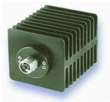
BW-40N100W Постоянный аттенюатор 50 Ом, 40 Дб, 100 Ватт
